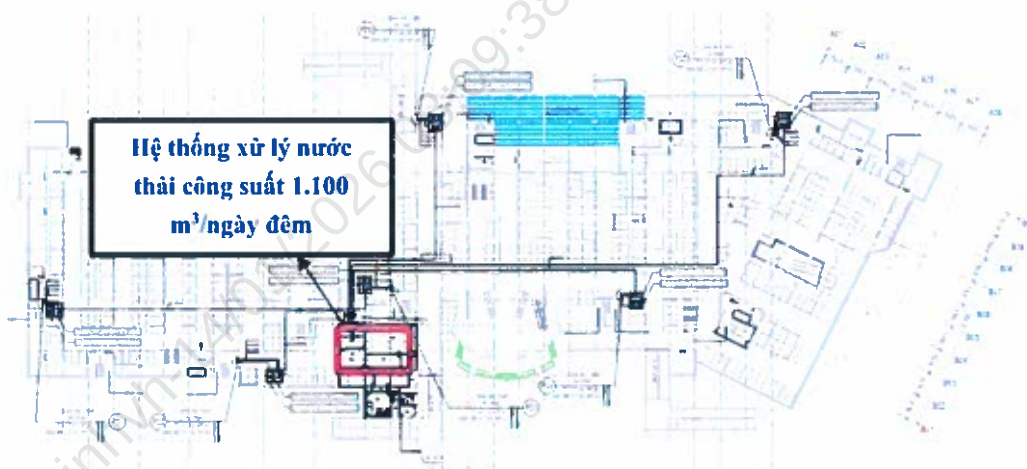
Hình 17. Vị trí hệ thống xử lý nước thải tại tầng ngầm
